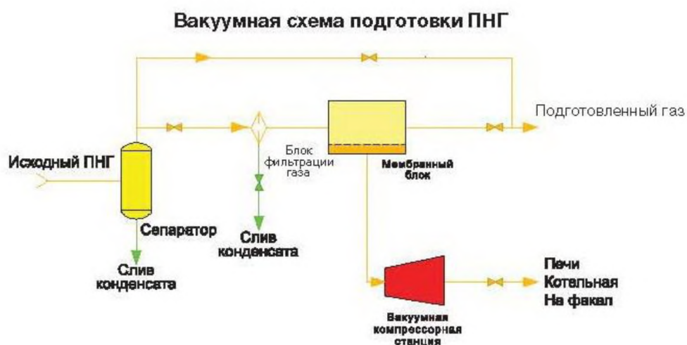
Рисунок 7.18 – Вакуумная схема мембранной подготовки ПНГ
